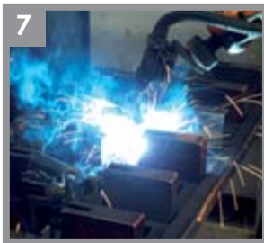
7 SALDATURA ROBOTIZZATA ROBOT WELDING SYSTEM
