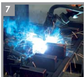
SALDATURA ROBOTIZZATA ROBOT WELDING SYSTEM
